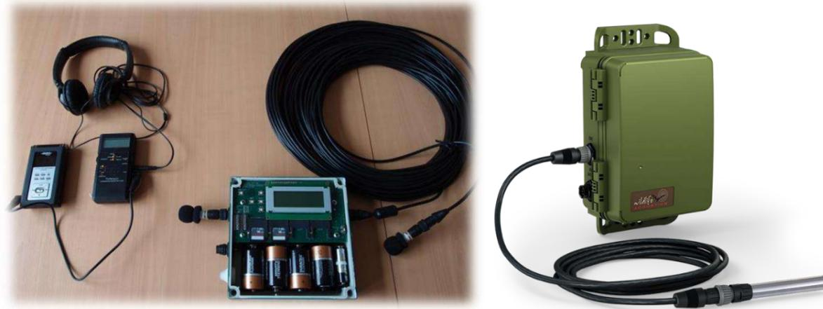
Figure 7 : Matériel acoustique utilisé pour les études sur les chiroptères
